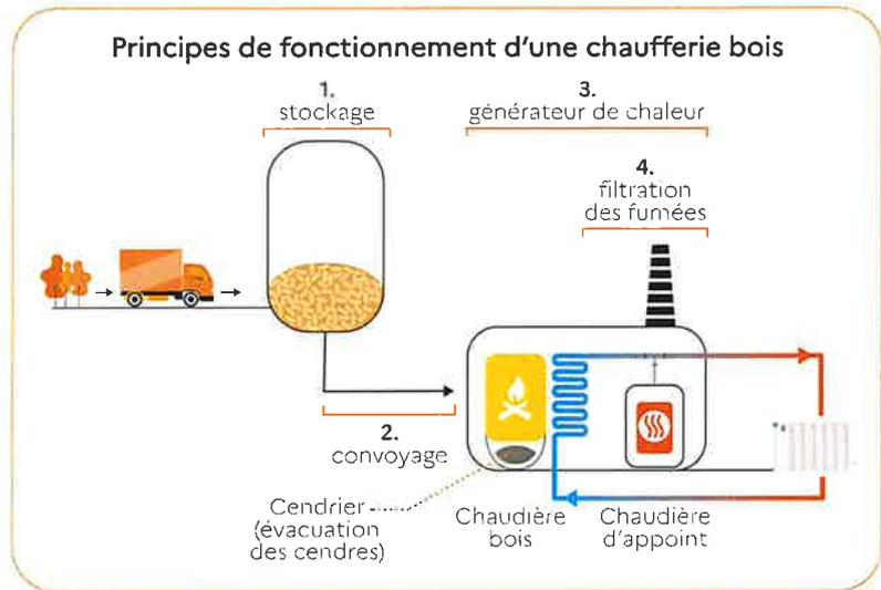
La chaleur produite permet de répondre aux besoins de chauffage de bâtiments (chaufferie associée ou non à un réseau de chaleur) ou à des process industriels (eau chaude, vapeur, air chaud).
